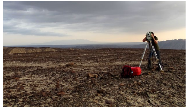
Mit einem Tachymeter wurde ein genaues Geländeprofil erstellt. Betreten werden durften die Linien nur von wenigen Personen mit Spezialschuhen.
