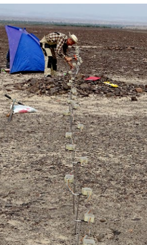
Geoelektrische Widerstandsmessung: Entlang einer Messlinie wurde durch Aneinanderreihung von Elektroden eine Signalspur erzeugt, die in einem Diagramm unterschiedlich reflektierende Strukturen im Boden wiedergibt.
